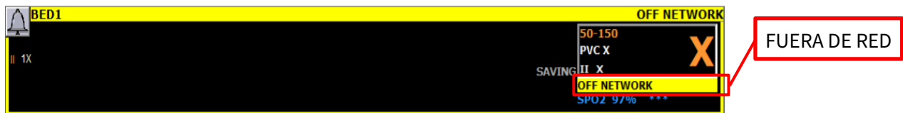
Figura 2. Ejemplo de la condición Fuera de red en la ventana del multivisor de la estación central, con indicadores de alarma acústicos y visuales (con un icono de campana y una barra de título que parpadea)
